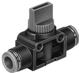
Afbeelding 5.7: Handbediende 3/2-stuurventiel met vergrendelfunctie
