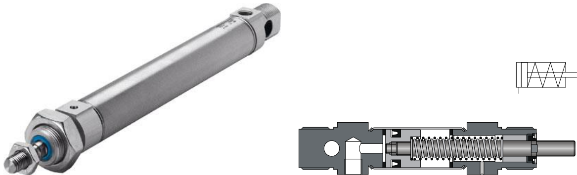
Afbeelding 5.4: Foto, doorsnede en symbool van een enkelwerkende cilinder
