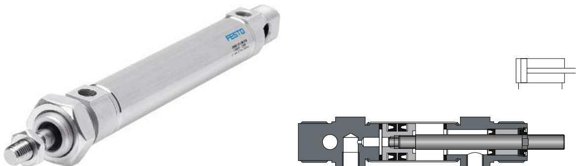
Afbeelding 5.5: Foto, doorsnede en symbool van een dubbelwerkende cilinder
